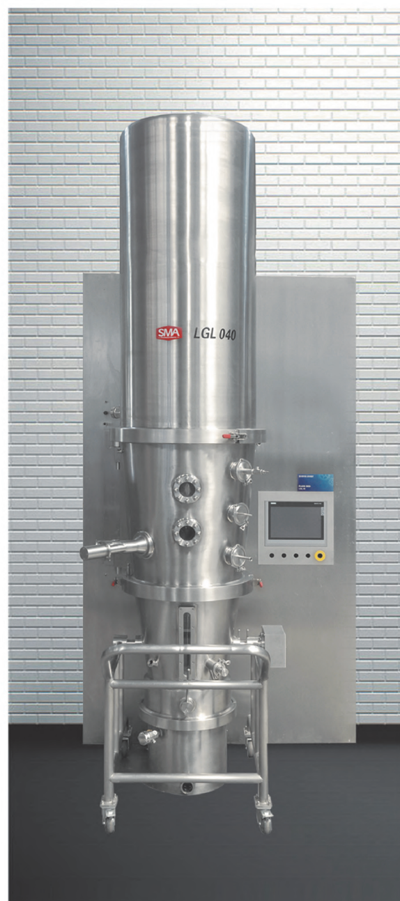
Внутрстенный монтаж выдерживает давление до 12 бар, соответствует требованиям АТЕХ.
